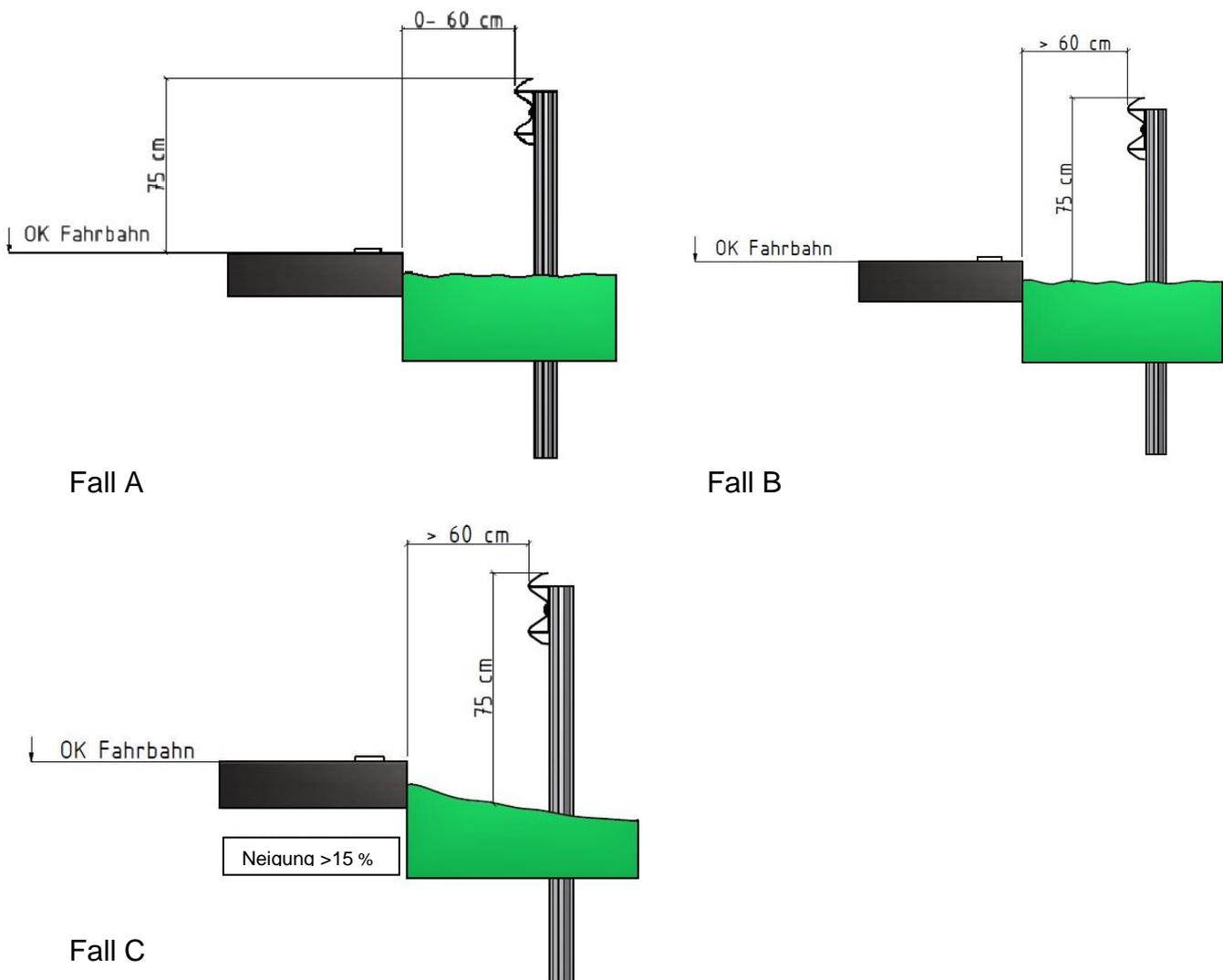
Borde mit einem Höhenunterschied von mehr als 7,5 cm sind zu vermeiden. Sind bereits höhere Borde vorhanden, die nicht mehr entfernt werden können, ist wie folgt vorzugehen:
