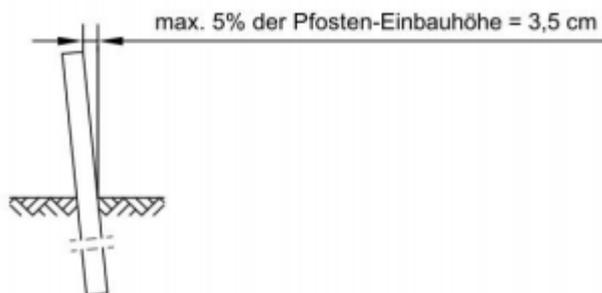
Die Pfosten sind lotrecht einzurammen. Abweichungen von maximal  $\pm 5\%$  Neigung (das entspricht  $\pm 3,5 \text{ cm}$  zu jeder Seite bezogen auf die Pfostenhöhe über Gelände) sind zulässig. Aufgrund von Rammhindernissen im Erdreich (z.B. Steine, Wurzeln usw.) kann es
